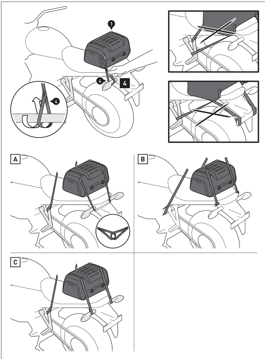
**Schritt [4]:** Verschlaufen Sie die Schlaufgurte (4) an **VIER** geeigneten und belastbaren Befestigungspunkten am Fahrzeug, wie in den Beispielzeichnungen **[A]** bis **[C]** gezeigt (z. B. Fußrastenaufnahme, Fahrzeugrahmen, Gepäckhaken etc.).
