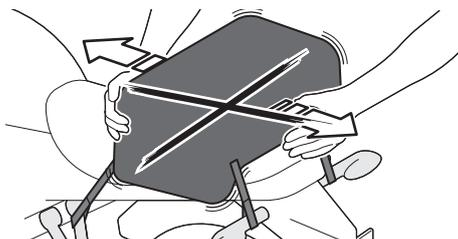
**Schritt [5]:** Haken Sie die Zurrhaken der **VI**ER Schlaufgurte (4) an den Zurrösen der Hecktasche (1) ein.
